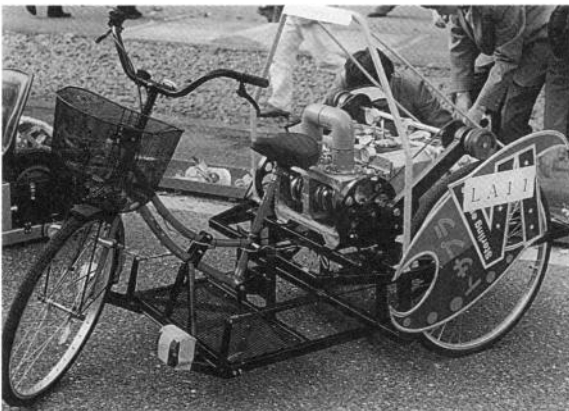
図3 \beta 形2気筒スターリングエンジンカー
