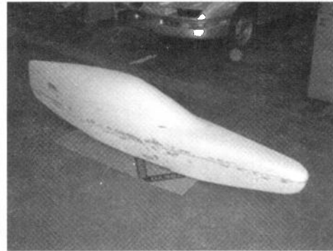
図10 ゲルコート塗布・表面研磨後
