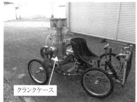
図11 今大会注目されアイデア賞を獲得したスコッチヨーク機構採用の車両
