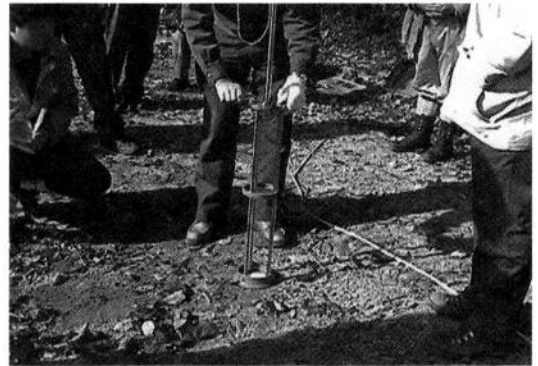
図4 手にしているのは路床土の耐荷重性（CBR値）を測定する装置。
